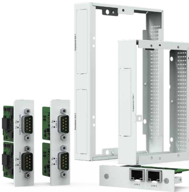
Eine optimale Ergänzung zum WAGO Edge Computer bilden die neuen Erweiterungsgehäuse und -module. Der mit einem Atom-Prozessor ausgestattete WAGO Edge Computer kann mit einem Erweiterungsmodul, der WAGO Edge Computer mit i7-Prozessor sogar mit bis zu zwei Erweiterungsmodulen ausgestattet werden. Dies ermöglicht eine kundenspezifische Konfiguration.
