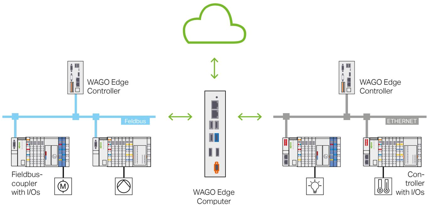
Die Grafik veranschaulicht das Zusammenspiel zwischen verschiedenen I/O-Devices (hier: Motor, Pumpe, Licht, Warmwasser) als Sensoren und/oder Aktoren und wie diese in das Gesamtsystem (hier: Gebäudeautomation) mithilfe von WAGO Edge Controllern und WAGO Edge Computern eingebunden werden.
