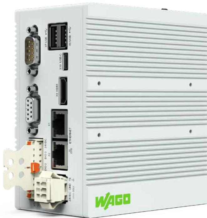
Der WAGO Edge Controller ist mit einem ARM-Cortex-A9-Quadcore-Prozessor ausgestattet und verfügt über zwei ETHERNET-, eine CANopen®, zwei USB-Schnittstellen, eine serielle Schnittstelle sowie vier digitale Ports für die Anbindung lokaler I/O-Geräte.
